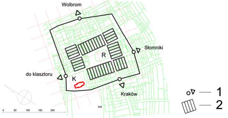
Ryc. 8. Próba rekonstrukcji układu lokacyjnych działek siedliskowych rozmierzonych w obrębie rynku w Skale na tle modularnej siatki mierniczej opartej na module 1 sznura. Opracowanie autora. L e g e n d a : 1 – bramy miejskie i kierunki powiązań komunikacyjnych miasta z okolicą, 2 – działki siedliskowe o wymiarach 18 × 72 łokcie, R – rynek, K – kościół parafialny
