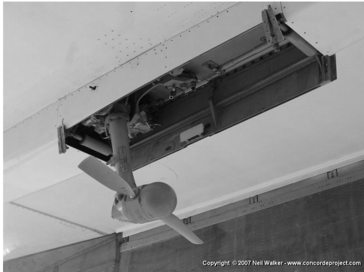
Rys. 2. Jednostka RAT zainstalowana na naddźwiękowym samolocie Concorde 4
