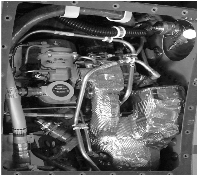
Rys. 5. Jednostka zasilania awaryjnego (EPU) zamontowana na samolocie F-16
