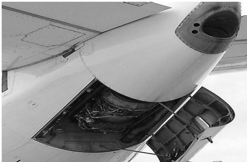
Rys. 1. Jednostka APU zainstalowana na samolocie Boeing 737 2
