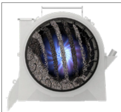
Rys. 3. Proces suszenia kruszywa w suszarni bębnowej
