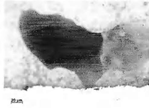
Rys. 7. Duży por uwięziony w ceramice pow. 500x
