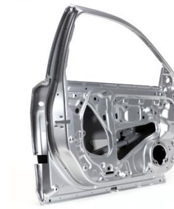
Rys. 22. Struktura stalowo-aluminiowa drzwi pojazdu samochodowego firmy Honda
