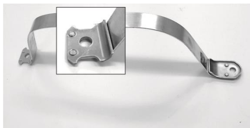
Rys. 17. Obejma służąca do zamocowania zbiornika paliwa
