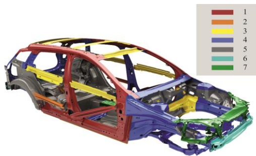
Rys. 1. Przykład zastosowania materiałów konstrukcyjnych na elementy nadwozia pojazdu samochodowego: 1- stopy magnezu, 2- stopy aluminium, 3- stal niskowęglowe do głębokiego tłoczenia, 4- stале o podwyższonej wytrzymałości HSS, 5- stале o wysokiej wytrzymałości, 6- stале o bardzo wysokiej wytrzymałości, 7- stале o ultra wysokiej wytrzymałości
