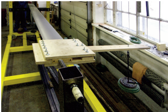
Rys. 1. Łopata wiatrakowca podczas pomiaru: a) sztywności skrętnej, b) ugięcia pod własnym ciężarem mierzonego względem promienia lasera [W. Krzymień 2010]
