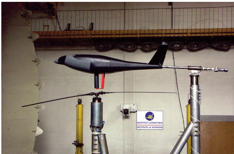
Rys. 5. Model kadłuba wiatrakowca i wirnika nośnego podczas badań w tunelu aerodynamicznym [G. Krysztofiak 2011]
