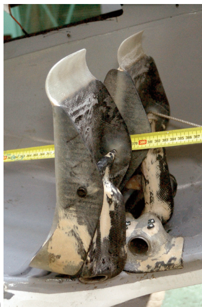
Rys. 7. Pomiar sztywności układu sterowania sterem kierunku: a) lekkie pedały metalowe, b) pedały kompozytowe wzmocnione [W. Krzymień 2013]
