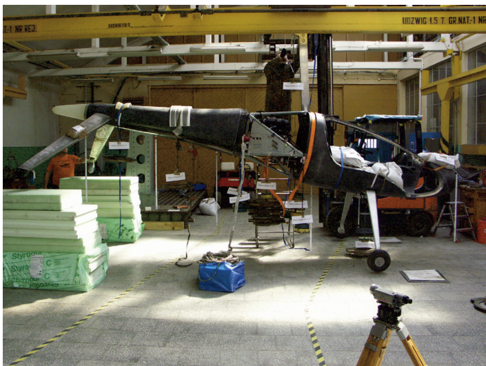
Rys. 10. Pomiar ugięcia kadłuba zawieszono wiatrakowca podczas próby „3g” [W. Krzymień 2012]
