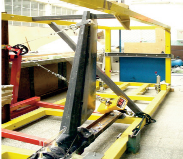
Rys. 9. Badania wytrzymałości i sztywności podwozia tylnego: rury skrętnej oraz goleni [J. Milczarczyk 2012]
