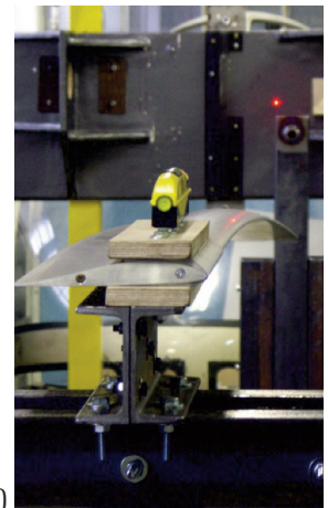
Rys. 1. Łopata wiatrakowca podczas pomiaru: a) sztywności skrętnej, b) ugięcia pod własnym ciężarem mierzonego względem promienia lasera [W. Krzymień 2010]
