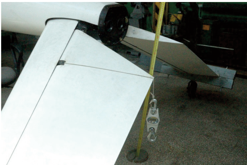
Rys. 8. Pomiar sztywności układu wychylania sterów [W. Krzymień 2013]
