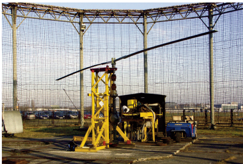
Rys. 4. Wirnik wiatrakowca podczas badań stoiskowych [W. Krzymień 2012]
