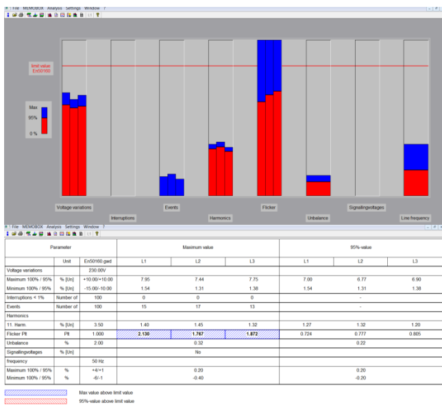
Rys. 4. Zestawienie zbiorcze parametrów jakości energii elektrycznej
