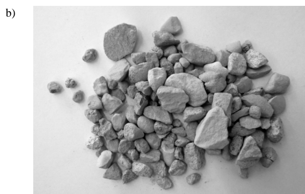
Rys. 4. Kruszywo recyklingowe: a) przed prażeniem, b) po prażeniu i odspojeniu w bębnie LA
