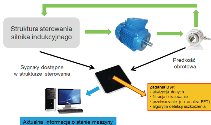
Rys. 7. Koncepcja działania systemu diagnostycznego z detektorem neuronowym
