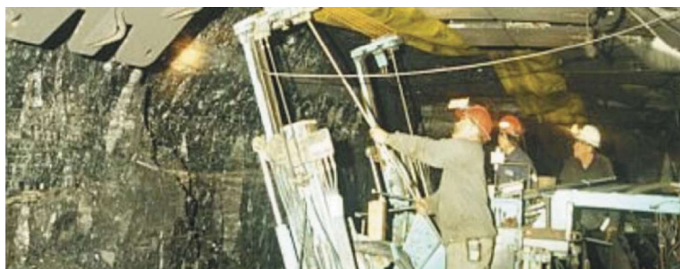
Rys. 11. Face Bolter firmy ARO Longwall w trakcie pracy pod ziemią (www.miningmonthly.com)
