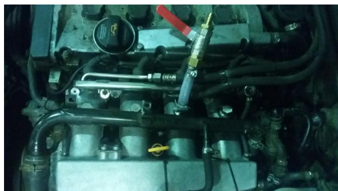
Rys. 1. Kolektor dolotowy silnika AWT 1.8T wraz z zamontowanym zaworem symulującym nieszczelność.
