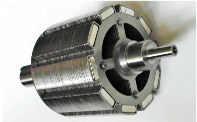
Rys. 2. Wirnik generatora z zagłębionymi magnesami trwałymi
