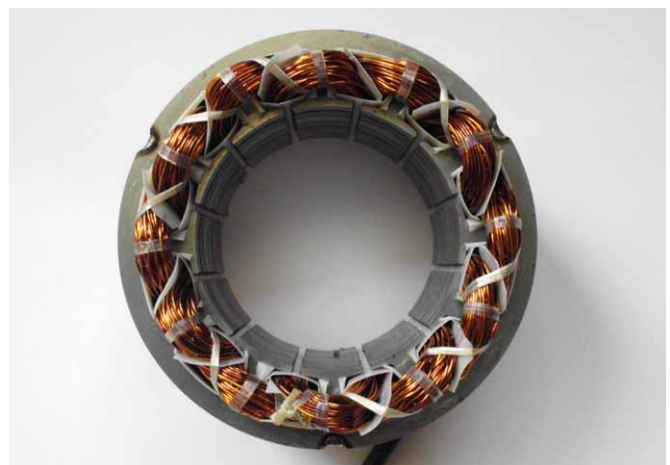
Rys. 3. Stojan generatora z cewkami skupionymi
