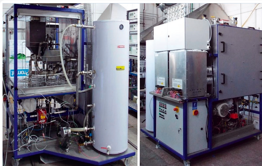
Fot. 3. Mikroukład kogeneracyjny z ogniwami paliwowymi SOFC o mocy elektrycznej 2 kW wraz z zasobnikiem 200 l na ciepłą wodę użytkową (zdjęcie autora)
