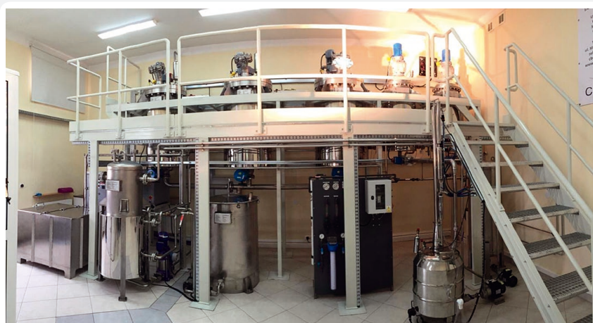
Fot. 5. Biorafineria do wytwarzania bioetanolu II generacji z masy lignocelulozowej [6] (zdjęcie autora)
