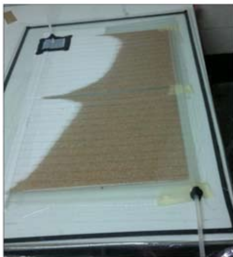
Rys. 1. Wytwarzanie biokompozytu metodą infuzji Fig. 1. Manufacturing of biocomposite by infusion method
