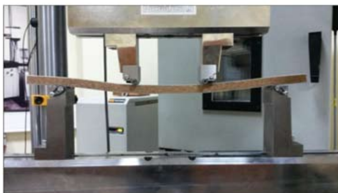
Rys. 4. Statyczne zginanie czteropunktowe próbki biokompozytu z materiałem rdzeniowym Corecork NL20 o grubości 15 \text{ mm}
