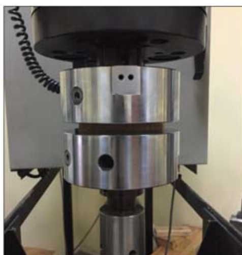
Rys. 5. Statyczna próba ściskania próbki biokompozytu z materiałem rdzeniowym Corecork NL20 o grubości 25 mm
