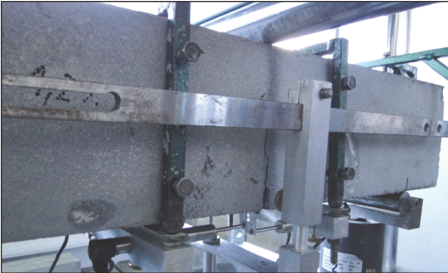
Rys. 4.23. Przykładowy sposób zniszczenia belki z włóknami stalowymi Fig. 4.23. Example of beam failure with steel fibers
