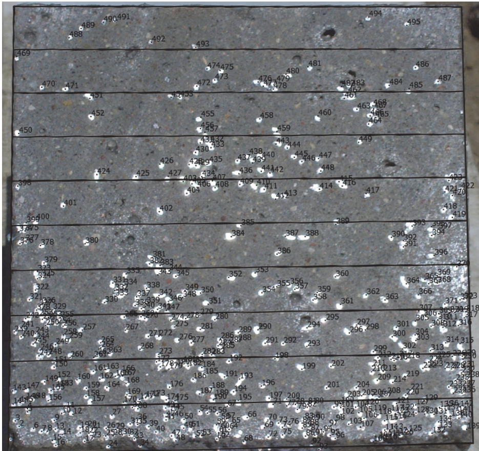
Rys. 5.3. Przykładowy przekrój próbki drobnokruszywowego fibrokompozytu z naniesionymi polami podziału i numeracją przekroju włókien (Głodkowska i Kobaka 2012)
