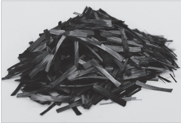
Rys. 3.11. Ogólny widok włókien węglowych typu PAN ( http://elenterprises.com )
