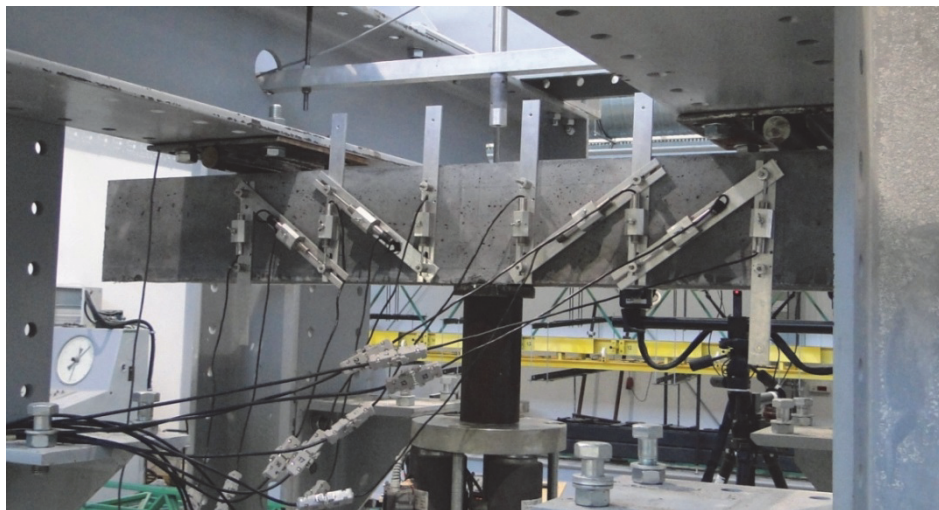
Rys. 6.60. Ogólny widok stanowiska badawczego wraz z czujnikami przemieszczeń (Głodkowska i Lehmann 2016/2017)
