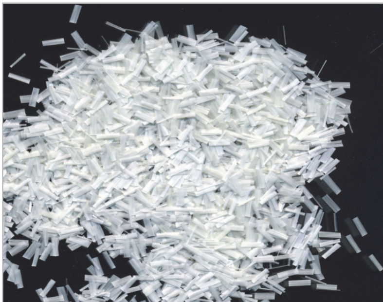
Rys. 3.10. Ogólny widok włókien szklanych typu E firmy Fibre Glast ( http://www.fibreglast.com )
