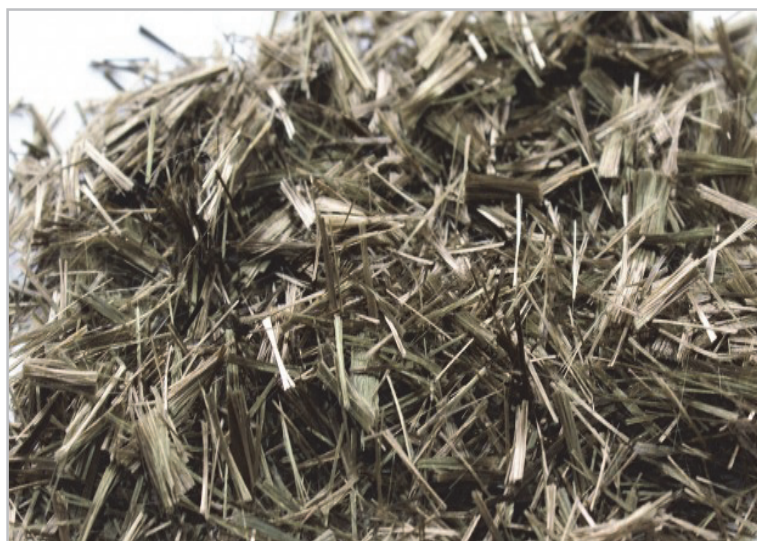
Rys. 3.13. Ogólny widok włókien bazaltowych ( http://basalt.today/2016/08/6322 )
