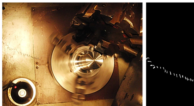
Rys. 7. Problem braku detekcji fragmentów wióra ze względu na refleksy światła – obraz W005_28 Fig. 7. The lack of chip parts detection caused by light reflections – image W005_28
