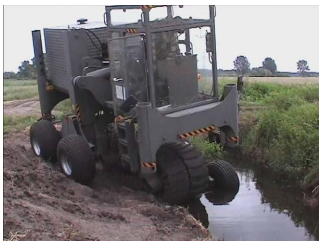
Rys. 4. Model doświadczalny podczas wjeżdżania do rowu Fig. 4. The testing model during movement into melioration ditch
