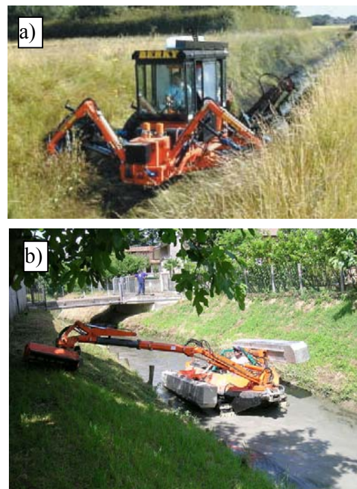
Rys. 2. Przykłady maszyn samobieźnych, pracujących w przestrzeni rowu melioracyjnego: a) maszyna firmy Berky, poruszająca się kołami po skarpach rowu [2], b) maszyna firmy Conver, poruszająca się na podwoziu gąsienicowym po dnie rowu [3]
