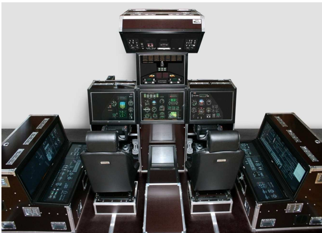
Rys. 1. Stanowisko szkolonego – kabina samolotu
