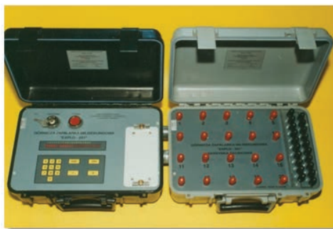
Fig. 12. Mining millisecond blasting machine Explo 201 (Biessikirski, 1996) Rys. 12. Górnicza Zapalarka Milisekundowa Explo 201 (Biessikirski, 1996)
