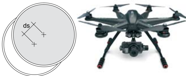
Rys. 4. Pomiar przemieszczenia na rzucie wylotu komina oraz dron z kamerą
