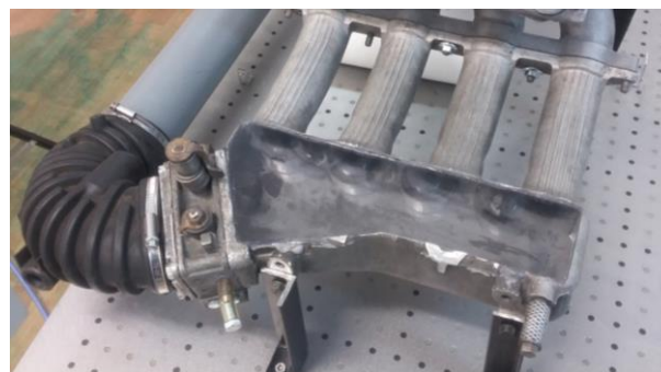
Rys. 7. Kolektor dołotowy wraz z badanym kolanem
