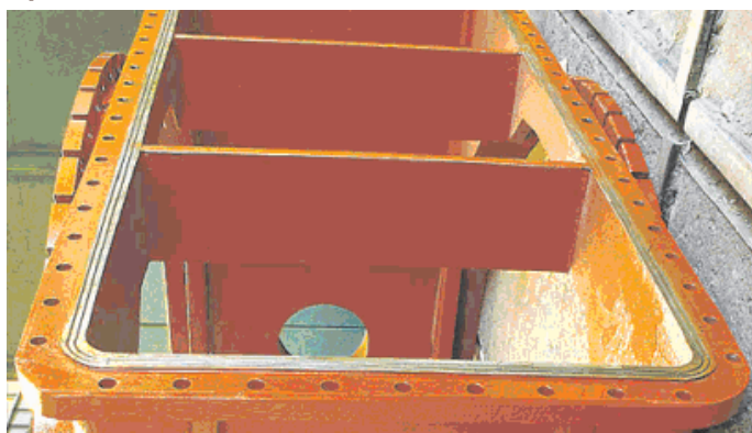
Rys. 2. Przykłady korpusów dzielonych: a) z płaszczyzną podziału przechodzącą przez osie głównych otworów, b) zamykanego pokrywą
