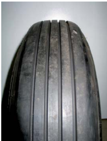
Fot. 2. Opona testowa PIARC RIBBED, rozmiar 165R15 [8]
