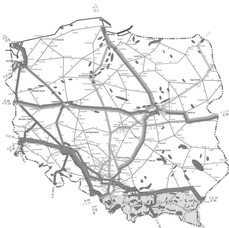
Rys. 1. Rozmieszczenie osuwisk w Polsce a główne linie kolejowe {3}
