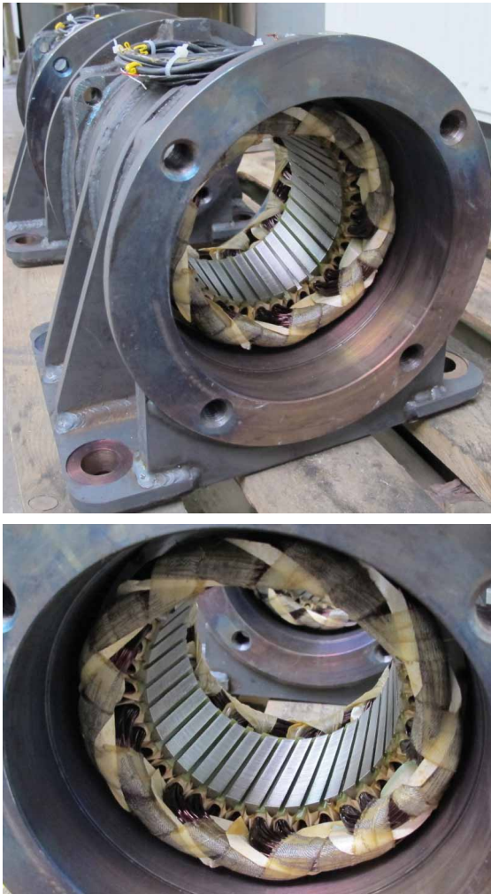
Rys. 2. Uzwojony stojan silnika PMSM osadzony w korpusie stalowym spawanym. Uzwojenie rozłożone quasi-sinusoidalnie, jednowarstwowe, 2 żłobki na biegun i fazę, skos żłobków stojana o pełną podziałkę żłobkową
