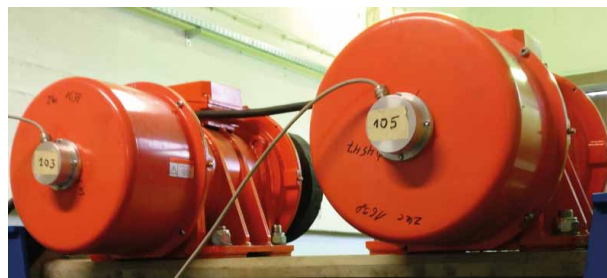
Rys. 5. Sposób zamocowania enkoderów inkrementalnych na modelowych elektrowibratorach z silnikami PMSM
