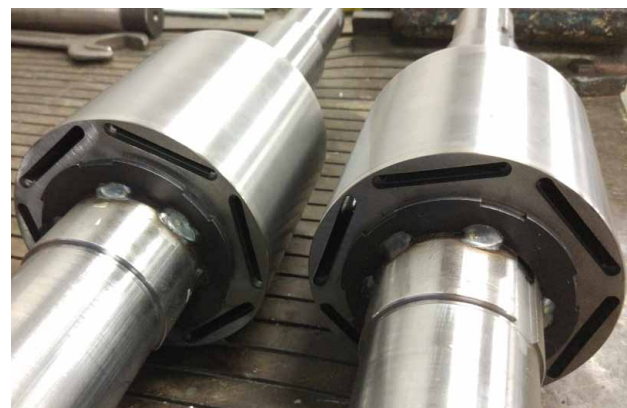
Rys. 3. Wirniki modelowych silników PMSM do elektrowibratorów o mocy 2 kW. Przy zastosowanym sposobie rozmieszczenia magnesów trwałych zwiększenie liczby biegunów skutkuje zmniejszeniem objętości i masy nabiegunków oraz pojedynczego magnesu trwałego
