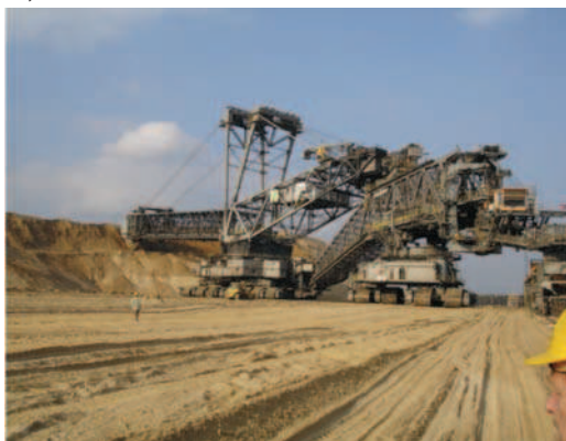
Rys. 3. Maszyny podstawowe w kopalniach węgla brunatnego: a) koparka wieloczerpakowa kołowa, b) zwałowarka
