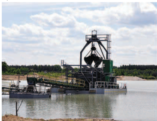
Rys. 4. Przykłady technologii wydobycia kruszyw żwirowo-piaskowych spod wody: a) pływającą pogłębiarką chwytakową, b) koparką jednonaczyniową z łądu
