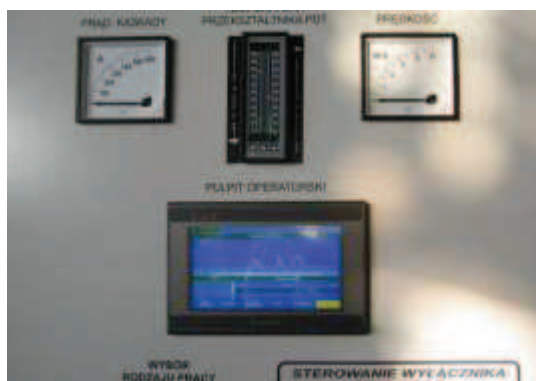
Rys. 3. Pulpit układu sterowania maszyny wyciągowej [1] Fig. 3. Control board of the control system of the winding machine [1]
