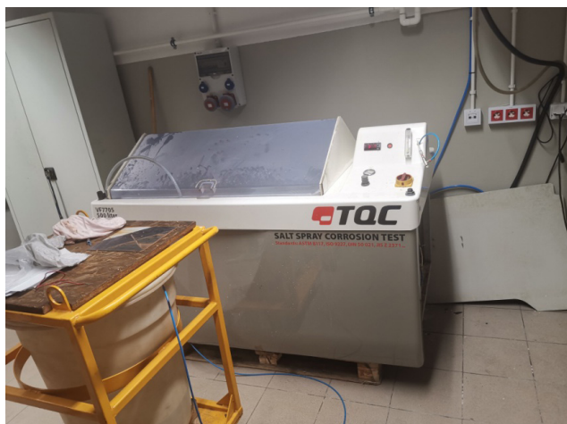
Rysunek 1 Fotografia komory solnej w przedsiębiorstwie Samasz. Źródło: opracowanie własne
