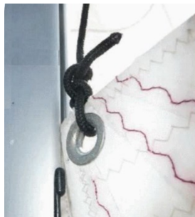
Rys. 2. Pętla na linie wykonana za pomocą węzła niezabezpieczonego [5]
