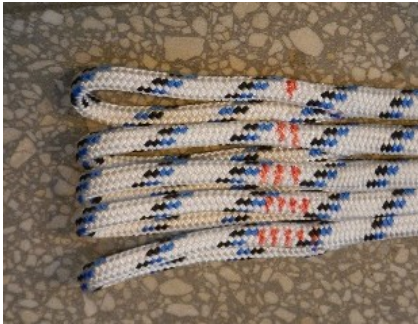
Rys. 15. Oznaczenie zakończeń próbek numerami porządkowymi na przykładzie: a) oznaczenie pętli, b) oznaczenie końca liny
