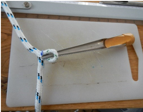
Rys. 9. Czynności przygotowawcze wykonania połączenia: a) wyznaczenie długości wplotu, b) rozsuwanie włókien, c) wydobywanie rdzenia, d) przygotowanie międzyoplotu
