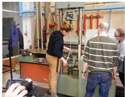
Rys. 16. Seria próbna: a) mocowanie próbki, b) rozciąganie próbki
