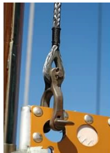
Rys. 3. Pętla na linie wykonana za pomocą przeplotu i opaski z juzingu [3]
