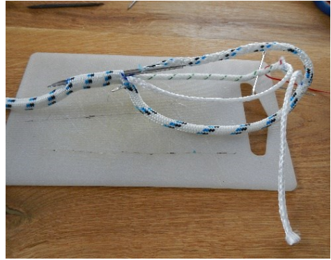
Rys. 10. Prace nad oplotem: a) taperowanie, b) tworzenie pętli
