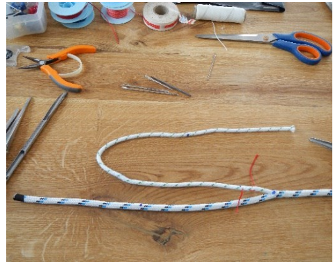
Rys. 9. Czynności przygotowawcze wykonania połączenia: a) wyznaczenie długości wplotu, b) rozsuwanie włókien, c) wydobywanie rdzenia, d) przygotowanie międzyoplotu
