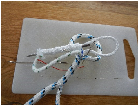
Rys. 11. Prace nad rdzeniem: a) wplatanie rdzenia, b) tworzenie pętli
