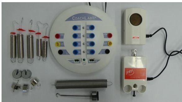
Rys. 12. Zdjęcie konsoli pomiarowej CoachLabII+ wraz z ultradźwiękowym czujnikiem położenia (prawy górny róg), czujnikiem siły (prawy dolny róg) oraz sprężynami i obciążnikami
