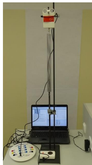
Rys. 13. Zdjęcie układu pomiarowego do badania drgań mechanicznych z wykorzystaniem konsoli pomiarowej CoachLabII+
