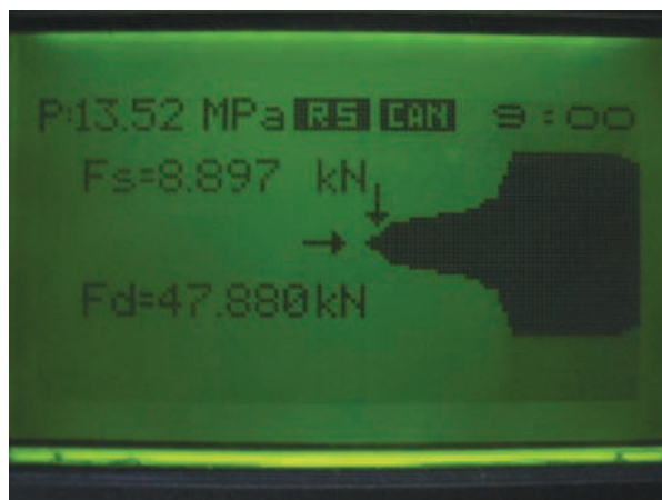
Rys. 5. Wyświetlacz POp-1 z wartościami sił oraz ciśnienia Fig. 5. Display of the POp-1 with force and pressure values
