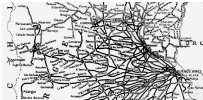
Il. 3. Sieć kolejowa środkowej Argentyny ok. 1946 r. Tor 1676 mm - linie czarne, tor 1435 mm - klasyczne oznaczenie kolei, tor 1000 mm - linie prostopadłe kreskowane
