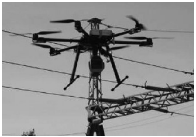
Fot. 6. Monitorowanie sieci trakcyjnej. (źródło: http://www.inzynierbudownictwa.pl/technika,narzedzia_i_maszyzny,artykul,zastosowanie_termowizji_z_wykorzystaniem_dronow_w_budownictwie )
