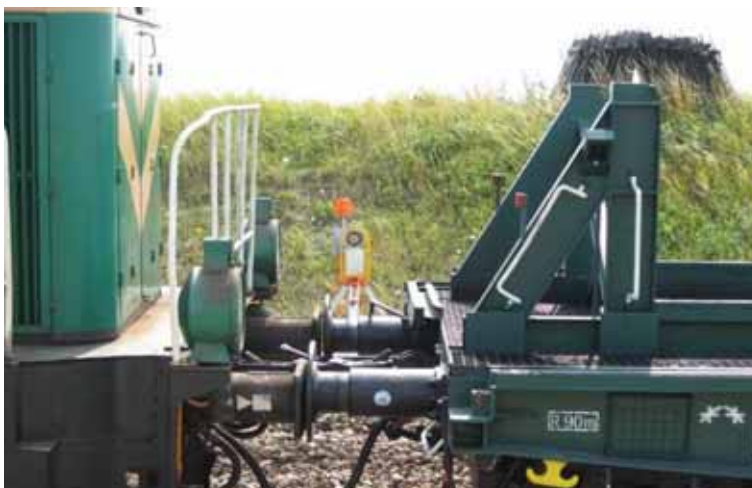
Fot. 5. Ustawienie sygnalizatora akustyczno-optycznego
