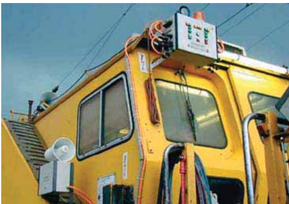
Fot. 3. Przykład rozmieszczenia sygnalizatorów na maszynie wysokowydajnej [6]
