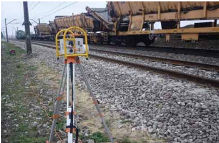
Fot. 9. Radiowy sygnalizatora akustyczno-optyczny ustawiony na statywie trójnożnym
