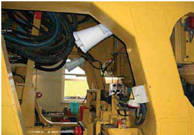
Fot. 4. Przykład rozmieszczenia sygnalizatorów na maszynie roboczej [6]
