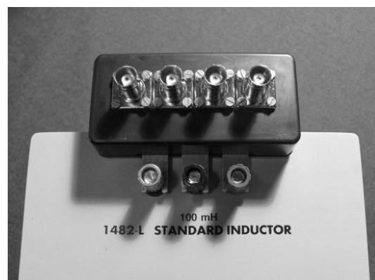
Rys. 2. Adapter czteroportowy podłączony do wzorca 1482-L Fig. 2. A four-terminal-pair adapter connected to the 1482-L standard
