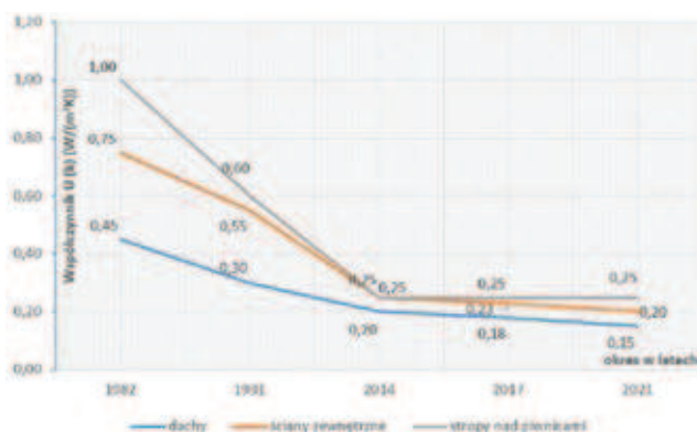
Rys. 1. Wymagania w zakresie ciepłochronności przegród budowlanych w latach 1982–2021
