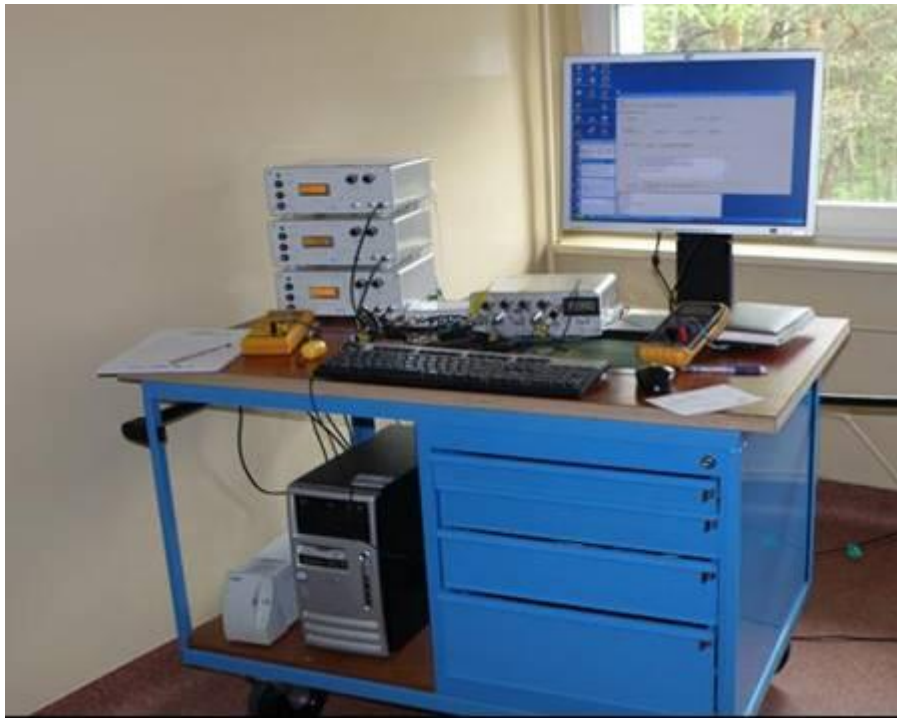
Fot.2. Trzykanałowa aparatura do pomiaru emisji akustycznej ( z lewej strony ) oraz dwukanałowy mostek tensometryczny (z prawej strony)
