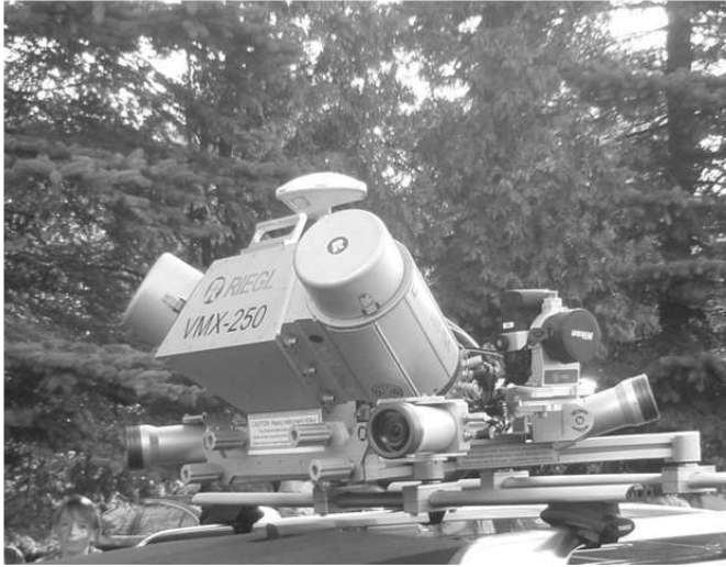
Fot. 3. System II oparty o rozwiązanie firmy RIEGL - VMX 250
