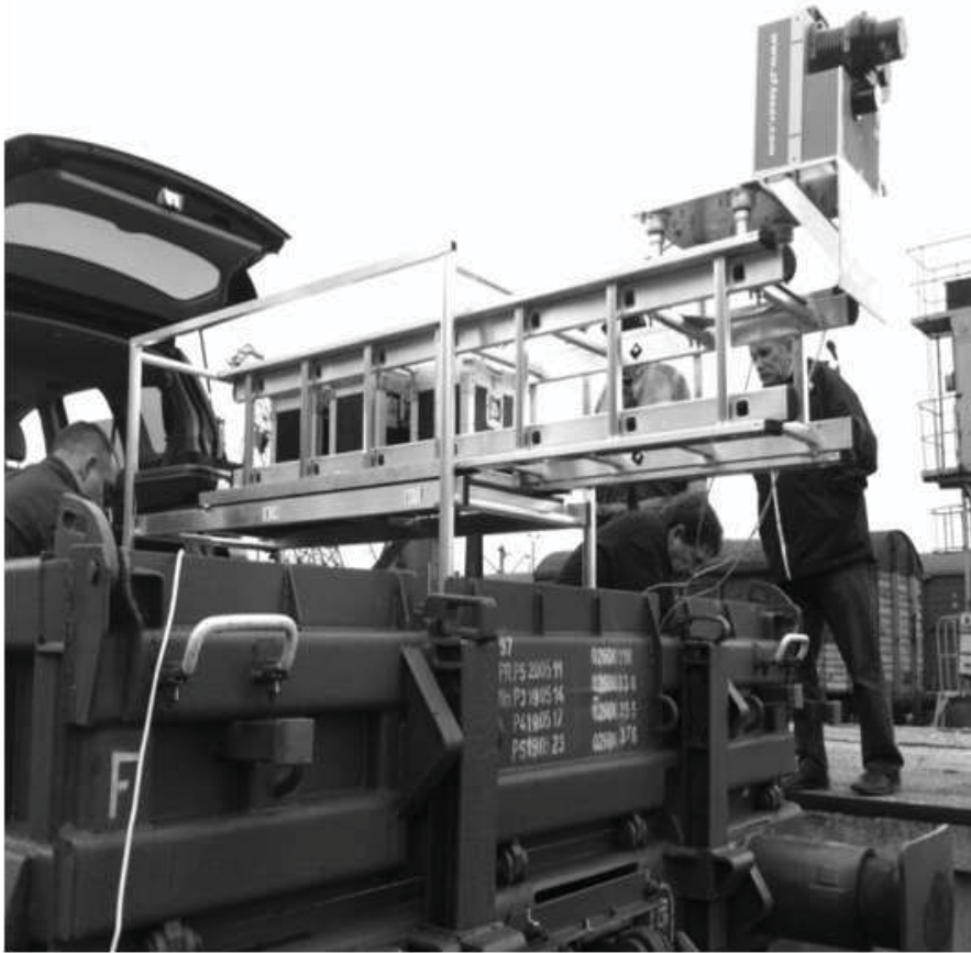
Fot. 2. System I – skaner Z+F Profiler 9000 podczas montażu na wagonie kolejowym
