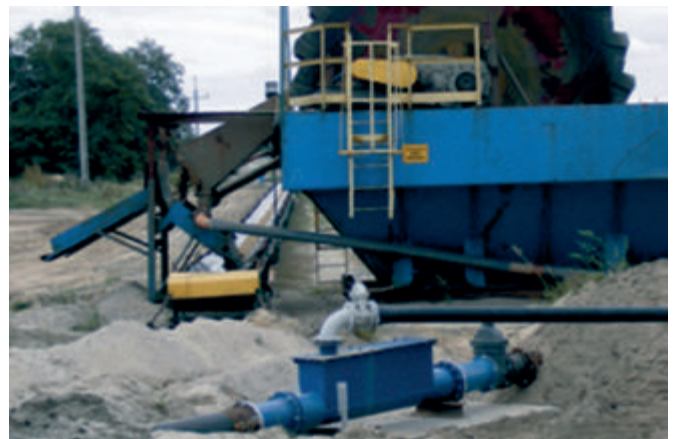
Fot. 7. Hydrokorektor lamelowy (SHL) podczas prób. Wariant I Photo 7. Lamellar hydroseparator (SHL) during testing (option I)
