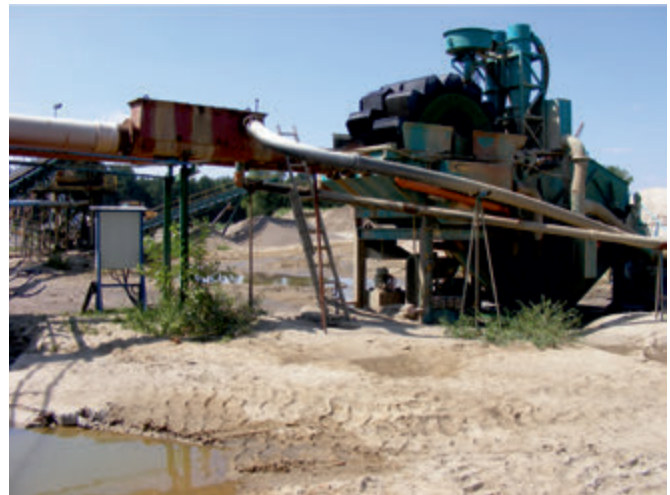
Fot. 2. Widok hydrokorektora membranowego. Wariant II Photo 2. Membrane hydroseparator (option II)
