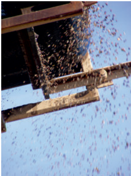
Fot. 10. Rozkład ziaren żwiru frakcji 2 - 8 mm w rzucie ukośnym z przenośnika Photo 10. Distribution of gravel's fraction 2 - 8 mm particles in oblique view from conveyor
