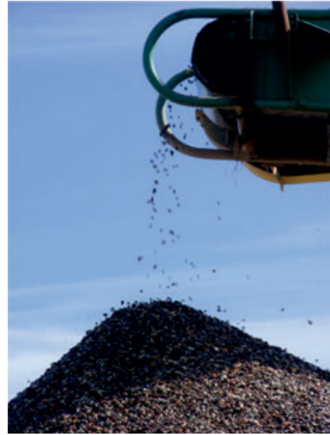
Fot. 11. Rozkład ziaren żwiru frakcji 8 - 16 mm w rzucie ukośnym z przenośnika Photo 11. Distribution of gravel's fraction 8 - 16 mm particles in oblique view from conveyor
