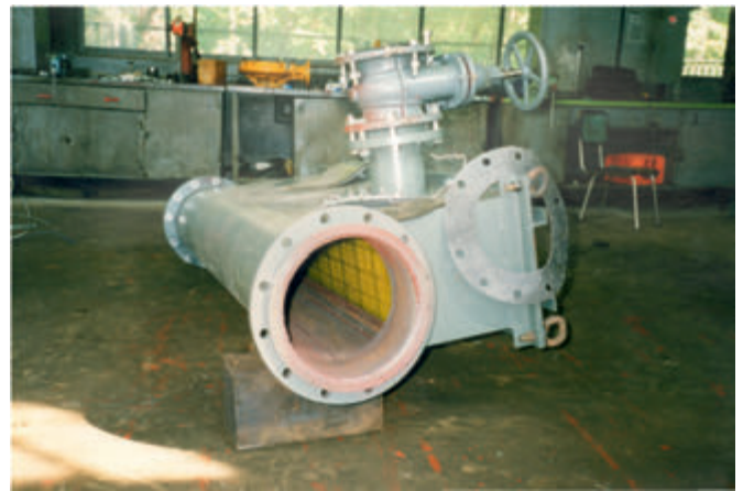
Fot. 6. Hydrokorektor membranowy Photo 6. Membrane hydroseparator
