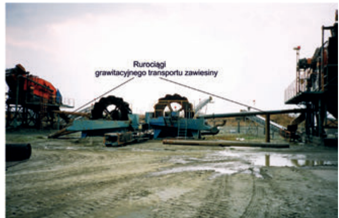
Fot. 4. Hydrotransport grawitacyjny od przesiewaczy. Wariant III Photo 4. Gravitational hydrotransport from screens (option III)
