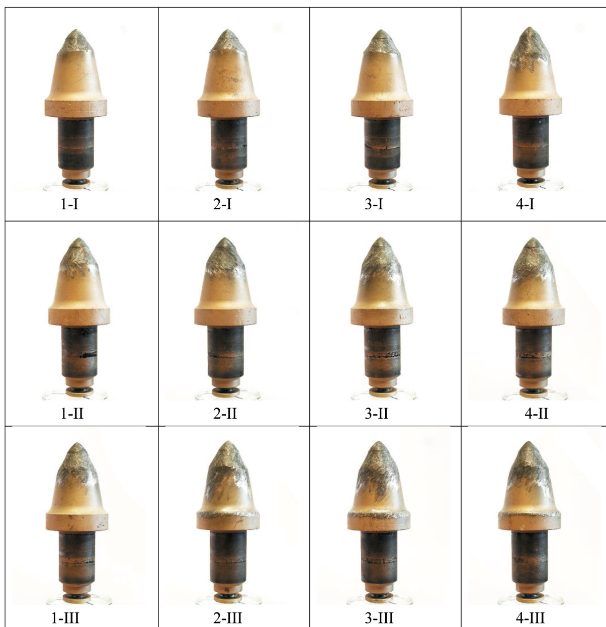
Rys. 9. Zdjęcia noży „handlowy 22” po badaniach wykonane co 120° względem osi noża
