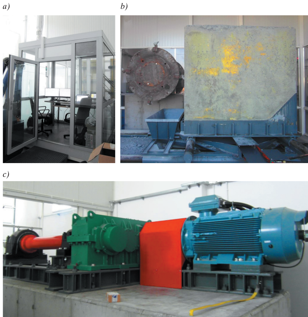
Rys. 5. Stanowisko laboratoryjne do badania procesu urabiania poprzez frezowanie lub wiercenie obrotowe pojedynczymi narzędziami skrawającymi lub organami: a) kabina operatora; b) betonowa próbka wraz z zespołem jej mocowania i posuwu oraz testowy organ urabiający; c) zespół napędowy organu urabiającego
