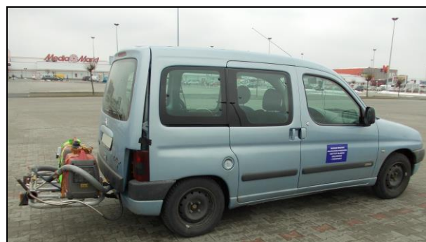
Rys. 3. Obiekt badawczy (Citroen Berlingo) przygotowany do przeprowadzenia testów drogowych
