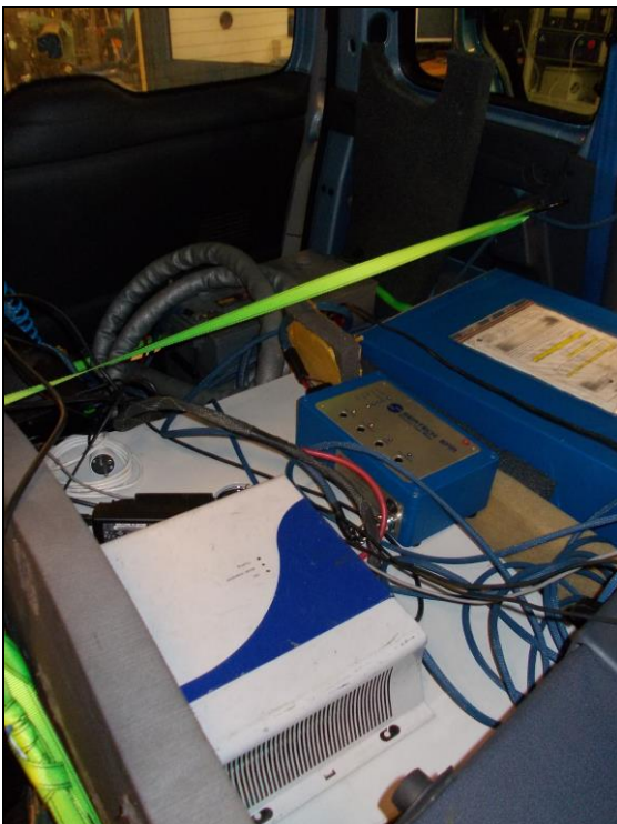
Rys. 4. Aparatura pomiarowa typu PEMS zamontowana w pojeździe badawczym
