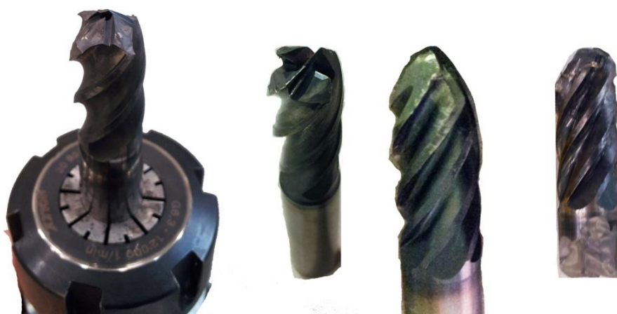
Rys. 3. Przykłady frezów po zużyciu katastroficznym
