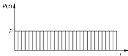
Rys. 3. Funkcja zmiany w czasie obciążenia dynamicznego
