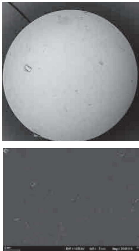
Rys. 3 a-b. Zdjęcia SEM jonitu Lewatit MonoPlus M 800 - powiększenia \times 400 przed sorpcją (a), \times 20.000 po sorpcji (b).
