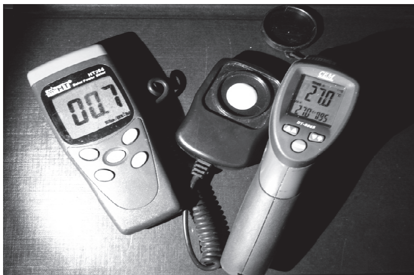
Rys. 1. Piranometr HT Italia 204 i pirometr CEM - DT-8865
