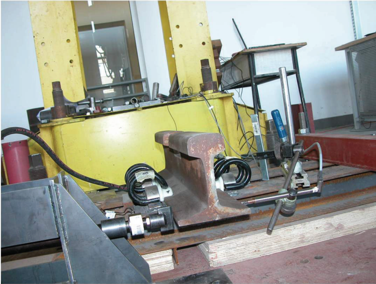
Rys. 7. Widok stanowiska do badania oporu na skręcanie przytwierdzenia CS-01
