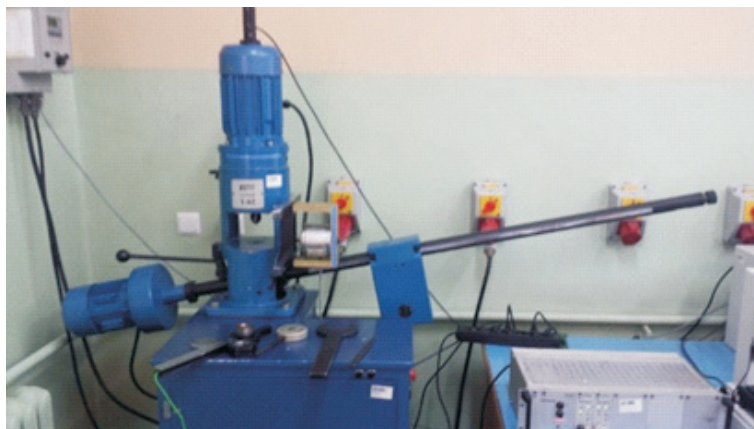
Rys. 16. Aparat czterokulowy T-02
