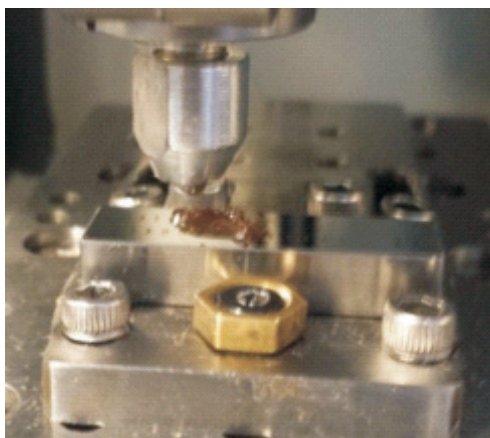
Rys. 19. Skojarzenie posuwisto-zwrotne UNMT
