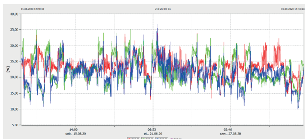
Rys. 2. Przebieg wyższych harmonicznych prądowych THDI
