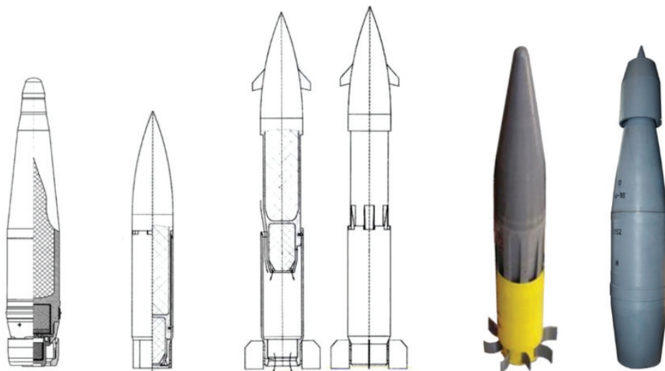
Rys. 3. Rysunki patentowe i modele 152 mm rosyjskich pocisków dalekonośnych, w tym z silnikiem strumieniowym. Opracowanie własne na podstawie [7]
