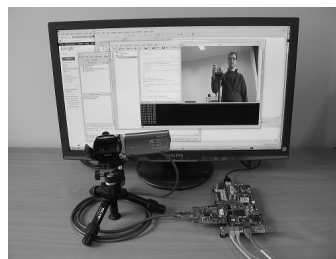
Rys. 4. Działający system: kamera, karta oraz obraz odbierany przez komputer Fig. 4. The working system: camera, board and received video stream
